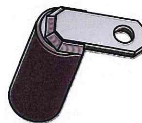
Sornik \text{Ø}30 \times 80 - PL 08 PV: M 1:2
