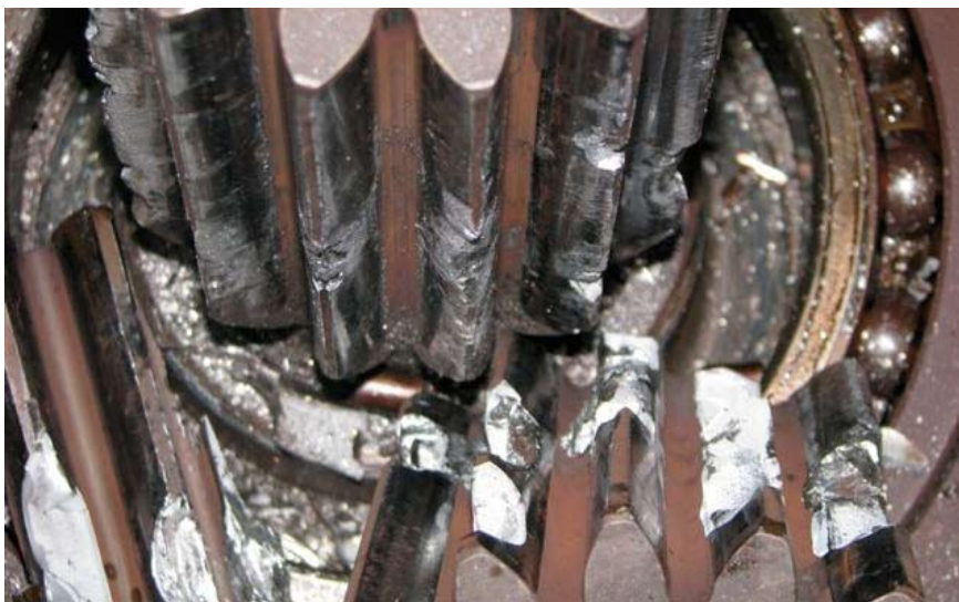
Poškodovan eden od treh manjših zobnikov planetnega dela reduktorja
