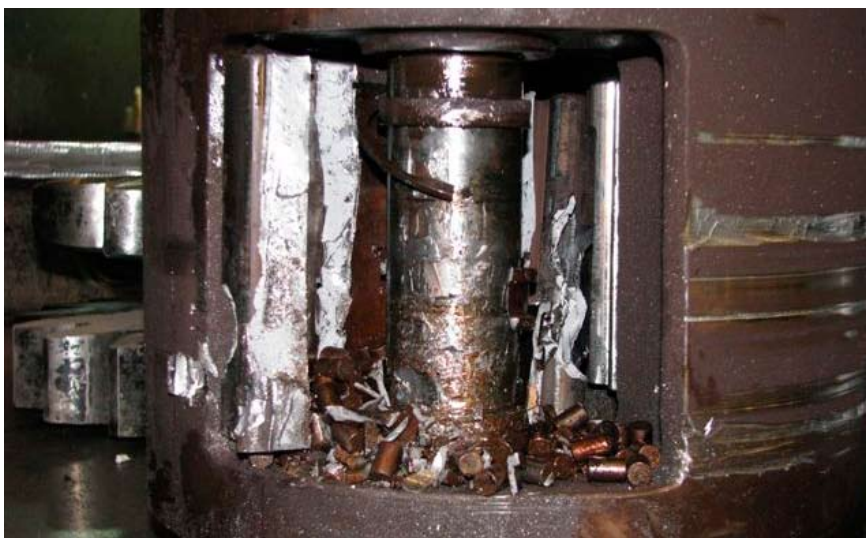
Poškodovan pastorek planetnega reduktorja
