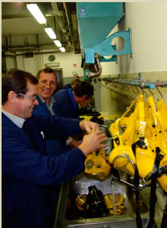
Reševalna vaja je tudi preizkus delovanja opreme – uporabljeno takoj po vaji prevzamejo skrbniki reševalnih aparatov, ki jo očistijo in znova pripravijo za uporabo.
