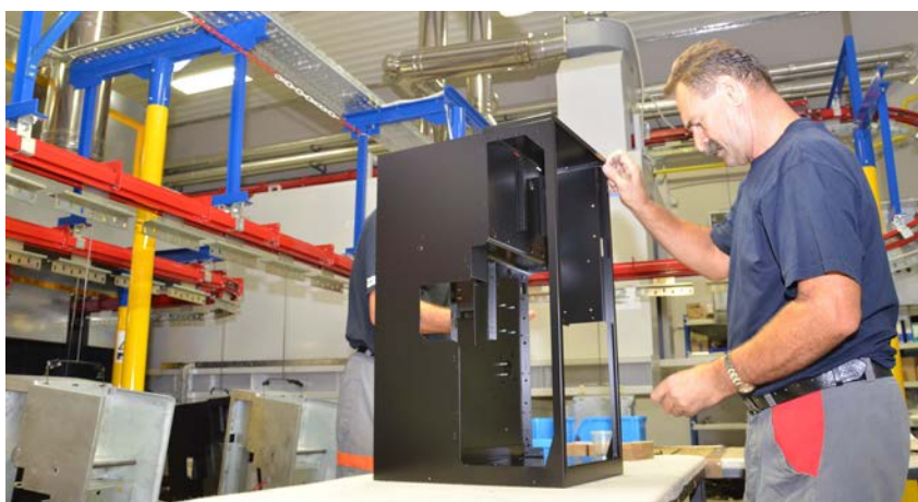
V novi lakirnici sestavljajo in prašno lakirajo lahke kovinske izdelke z uporabo barv brez topil in ta metoda je priznana kot okolju najbolj prijazen, najcenejši in najvarnejši način lakiranja. (foto: Mrki)
