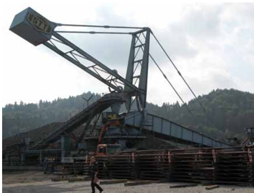
Korčasti deponijski bager za nakladanje premoga (foto: Alen Žolgar)
