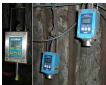
Točke merjenja hitrosti zraka na odkopu
