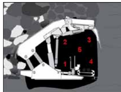
Točke merjenja hitrosti zraka na odkopu
