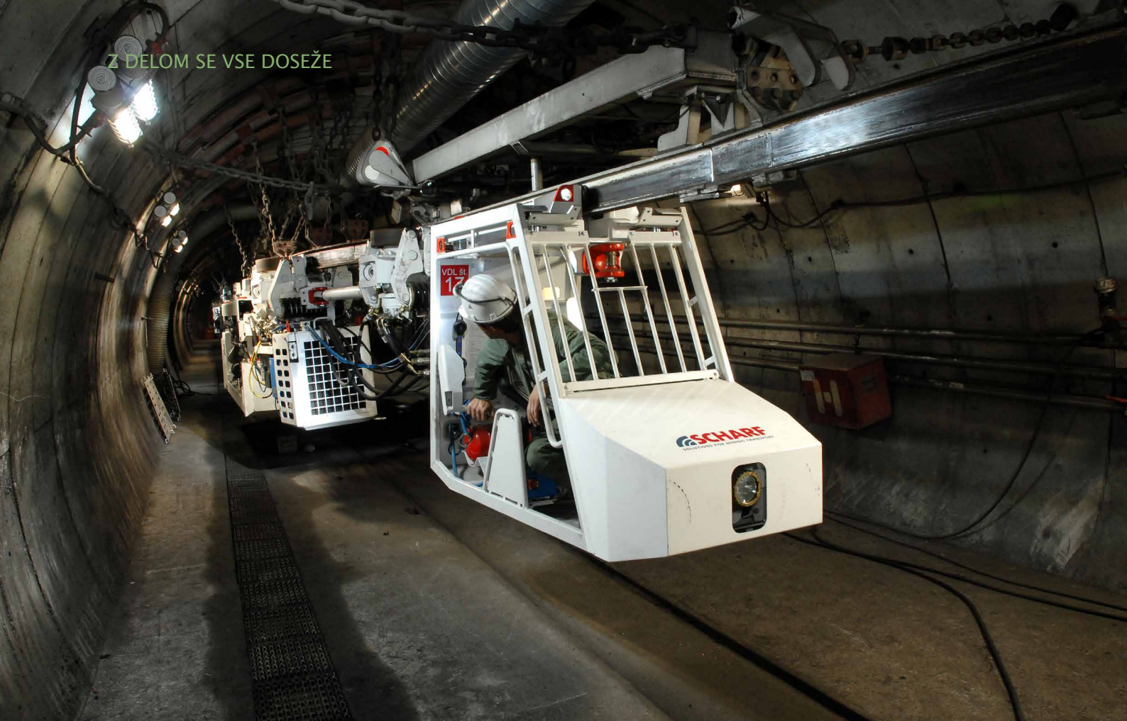
Viseča dizelska lokomotiva (VDL) je nepogrešljivi segment transporta v naši jami. (foto: Miran Beškovnik)
