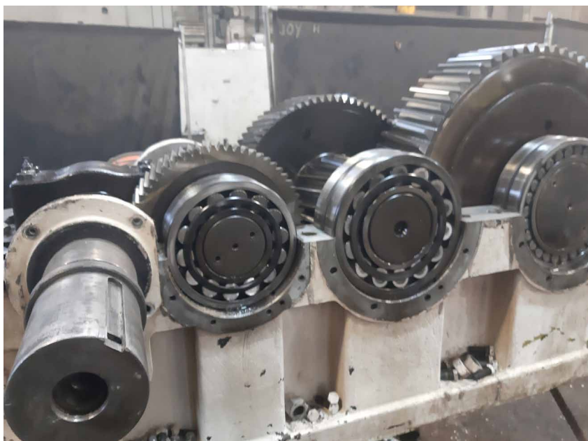
Slika remonta reduktorja CN 500
