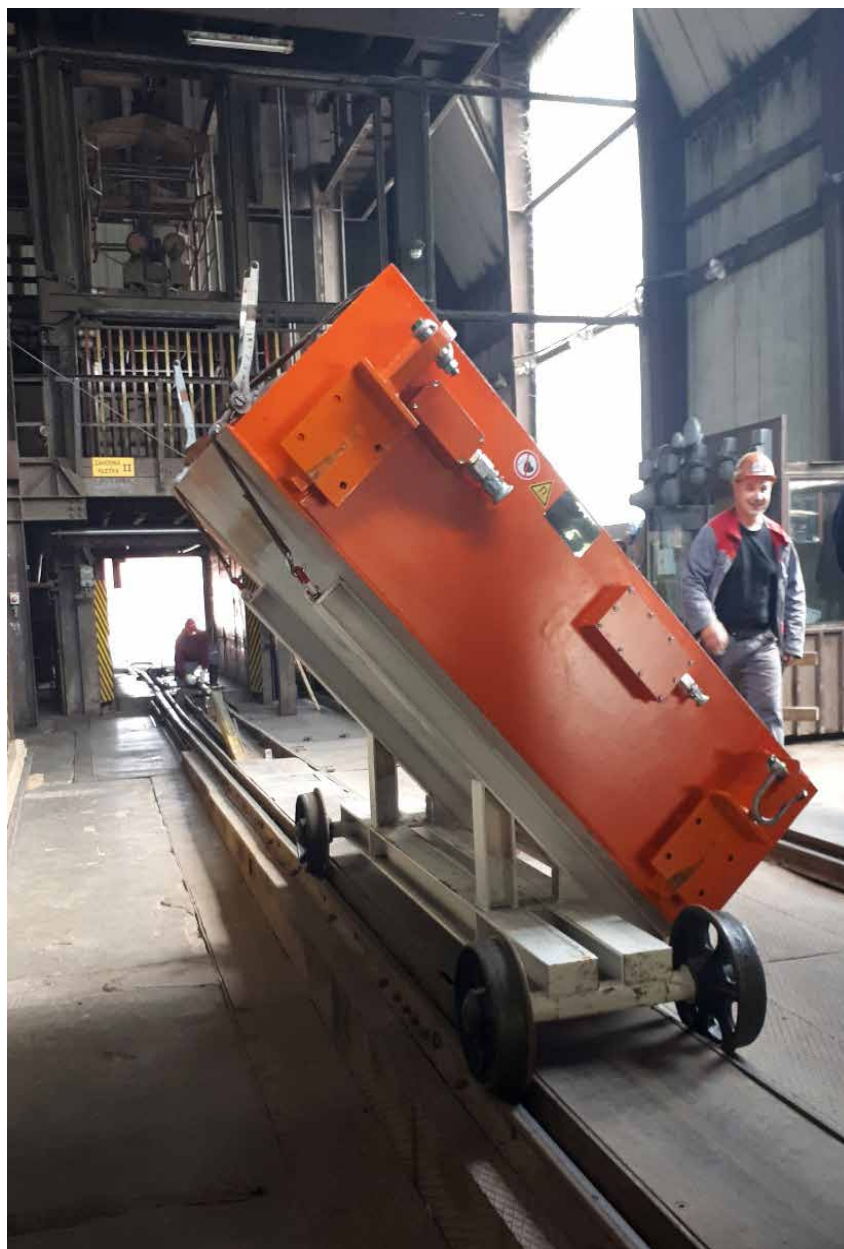
Transport separatorja na posebni vozni enoti
