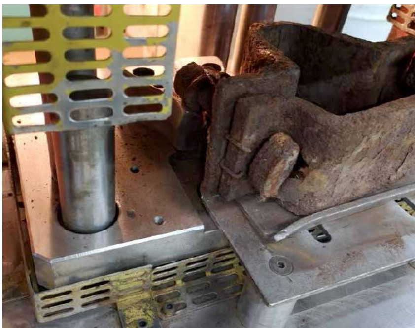
Orodje za razstavljanje vijčnih spon - sekanje matic
