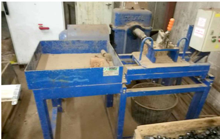
Stroj za demontažo vijčnih spon K-24 in TH-29
