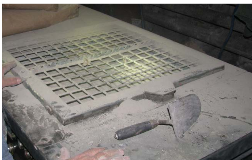
Vsipni del stroja je opremljen za zaščitno mrežo. Če želimo mrežo med delovanjem stroja odstraniti, se ta avtomatsko izklopi zaradi nameščenega varnostnega stikala.
