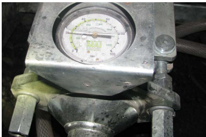
Merilec pritiska na črpalki; če pritisk naraste preko 20 barov je treba povečati pretok vode. Sicer stroj avtomatsko začne jemati samo vodo, zadrži nekaj suhega materiala in za rezultat imamo potem na šobi skoraj samo vodo.
