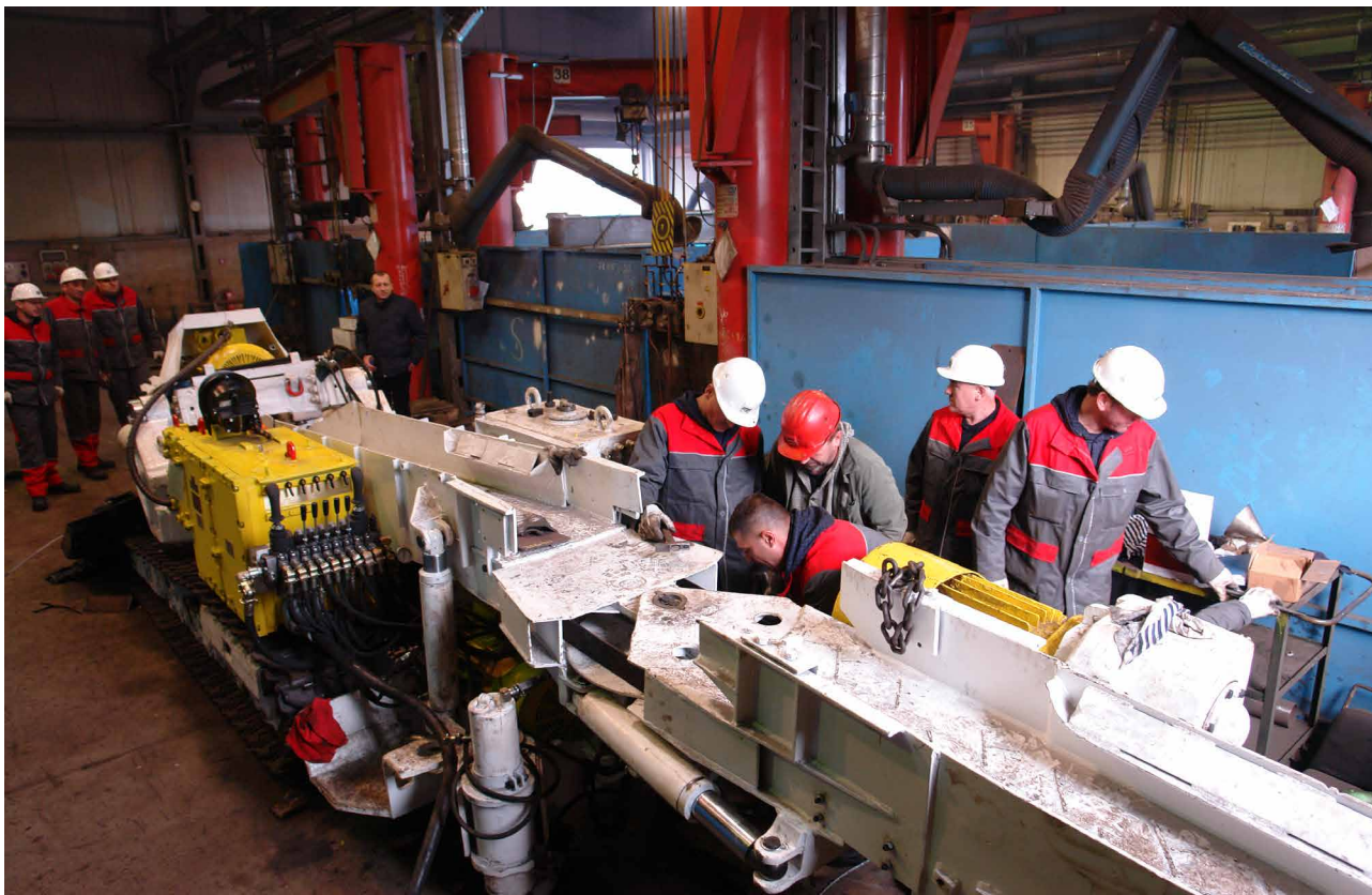
Prvi teden je vseh deset delavcev črnogorskega premogovnika pod budnim očesom mentorjev Premogovnika Velenje aktivno sodelovalo pri montaži njihovega napredovalnega stroja GPK. (foto: Slobodan Mrkonjić)
